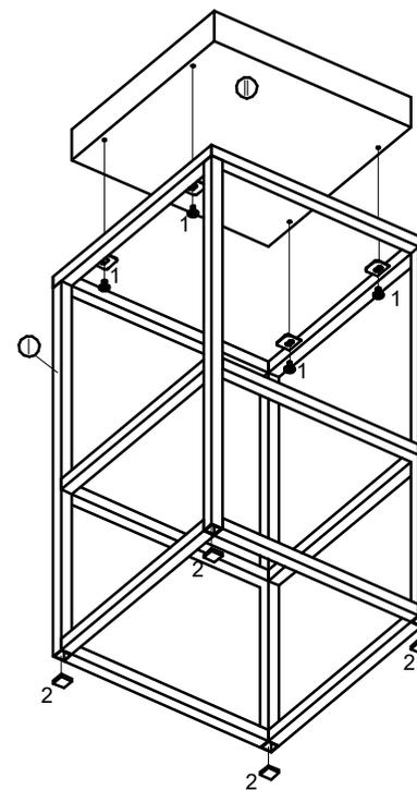
ПРИМЕЧАНИЕ: при сборке рекомендуем располагать стул таким образом, чтобы при вкручивании саморез заходил в отверстия снизу вверх.
